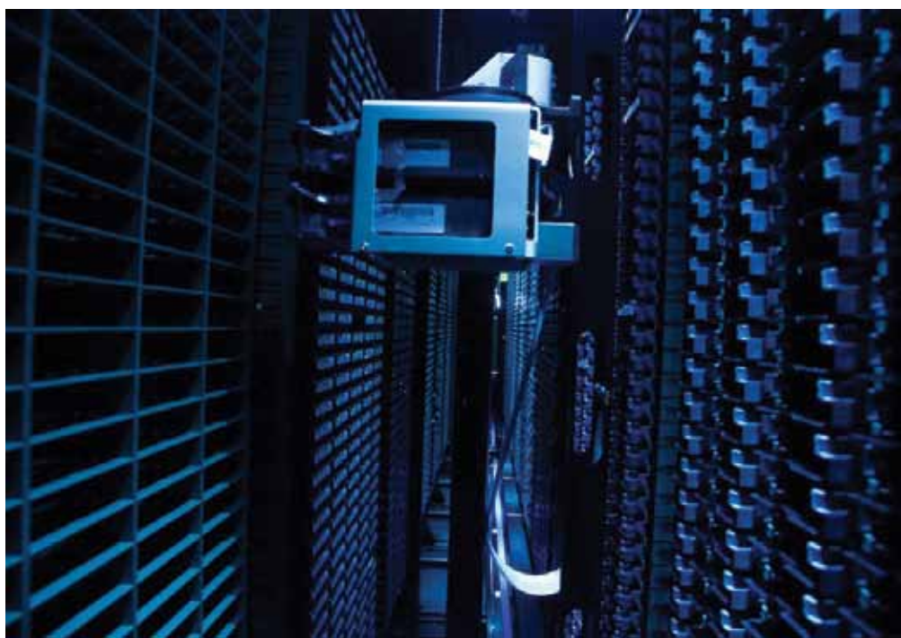
Velika robotizirana tračna knjižnica za arhiv podatkov, ki jo lahko povežemo s SAN.
